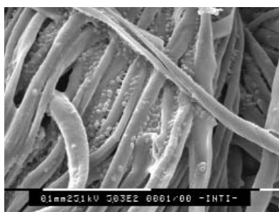
Microfotografía de un tejido impregnado con microcápsulas de levadura conteniendo aceite esencial de limón. Arriba, sin lavar; abajo, luego de un lavado
