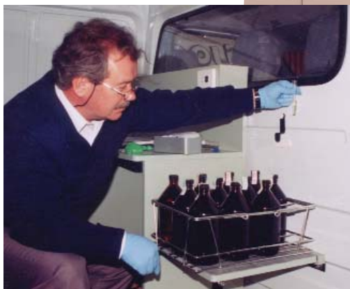
Verificación in situ de la presencia de trazadores en naftas
