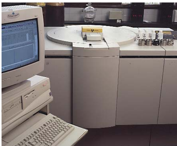
Equipo de Espectrometría de Fluorescencia de Rayos X empleado en el INTI para realizar la determinación
