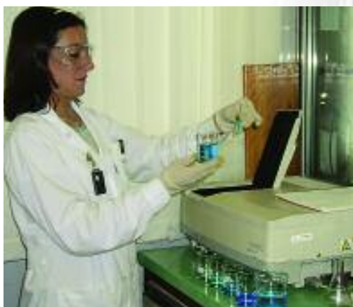
Medición del complejo de silicio por espectrometría de absorción UV-visible en solución
