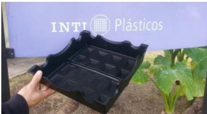
Diego Beronio es un desarrollador local de módulos para techos verdes; estas bandejas negras de 33 x 33 cm. de polipropileno realizadas con un proceso de termoformación en vacío tienen conexiones laterales, reservorio de humedad en la base y canal para instalar sistema de riego.
