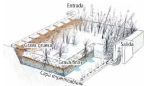
Planta fitodepuradora en el Ecobarrio Villa Sol, corredor de Sierras Chicas, Salsipuedes, Córdoba.
