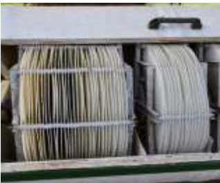
Biodiscos con tres etapas internas de discos.
