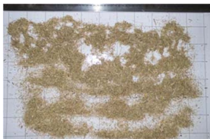
Imagen 6 - Molido de RAC con Molino de Martillo
