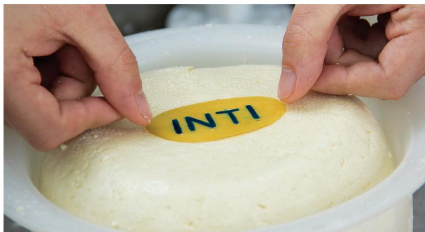
Profesionales del INTI alcanzaron una nueva formulación con el propósito de obtener placas de caseína mediante técnicas y procesos que se utilizan en la industria plástica. Este insumo permite identificar diferentes lotes de quesos para garantizar su trazabilidad e incrementar la participación de productos lácteos argentinos en el mercado internacional.
