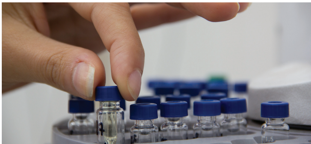
Equipo Rack con Viales. Contiene los extractos de las muestras a inyectar en el Cromatógrafo Gaseoso.
