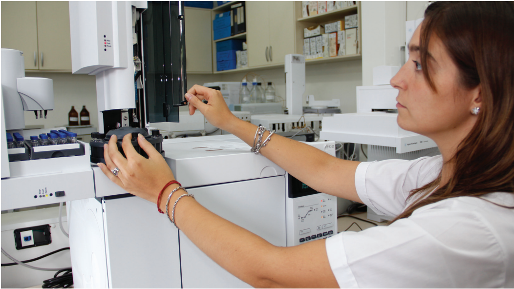
Cromatógrafo Gaseoso (GC). Determina los ácidos grasos (FAMES) con un detector de ionización de llama (FID).
