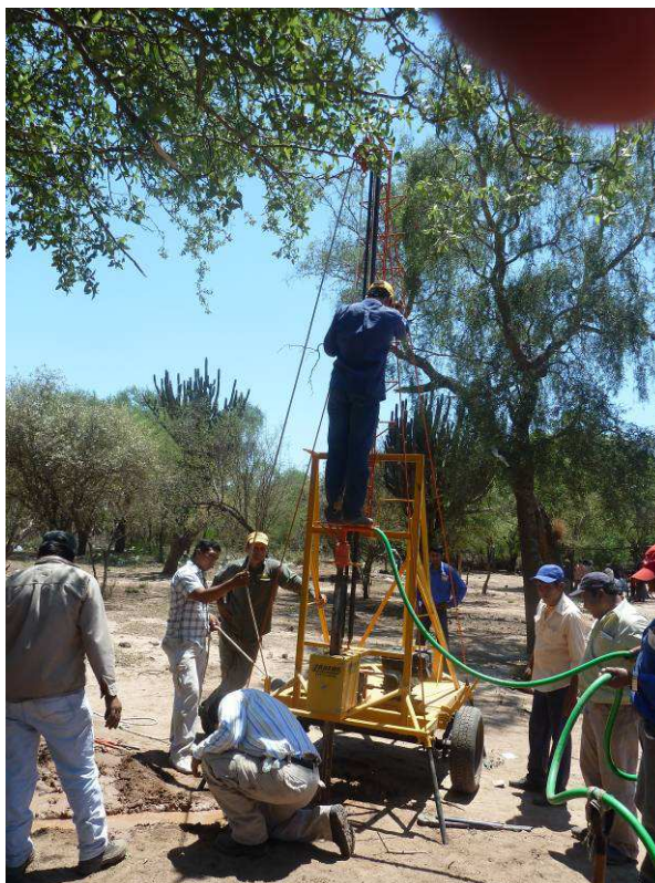
Figura 4.: La figura muestra al maquinista sobre la sarta de herramienta, para otorgar peso.
