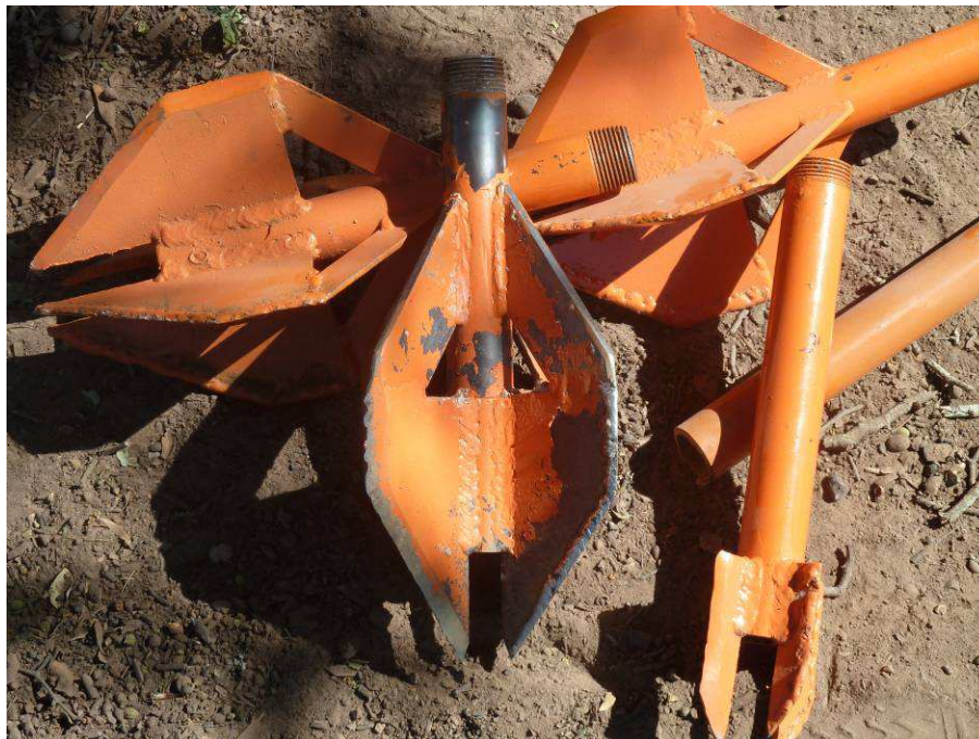
Figura 3.: La figura muestra los distintos trépanos.
