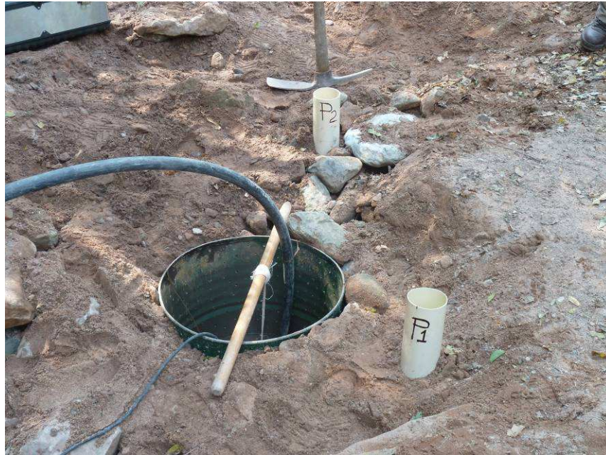
Figura 11.: Realización del ensayo de bombeo y recuperación.
