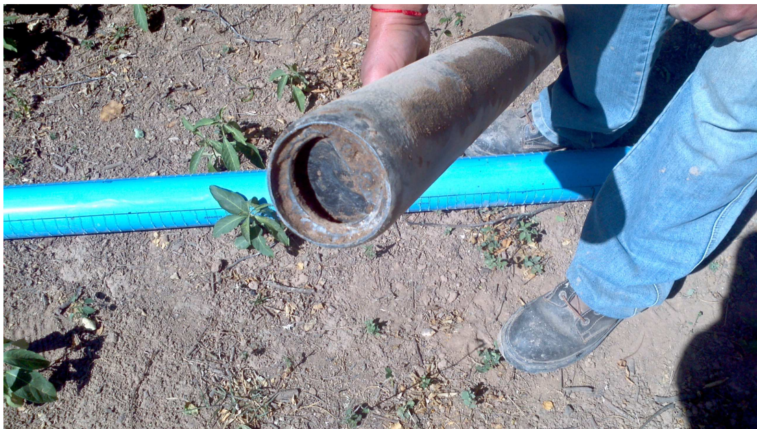
Figura 6.: Sonda manual, vista de la válvula de retención
