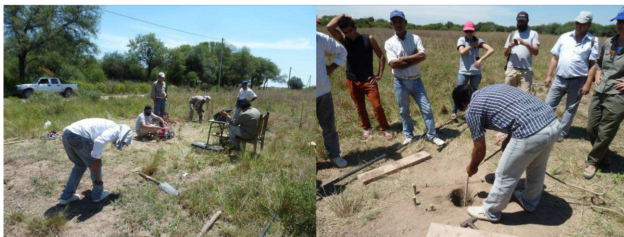
Figura 5.: A la izquierda se observa los estudios de SEV y a la derecha el pozo exploratorio donde el productor esta extrayendo un amuestra del agua.
