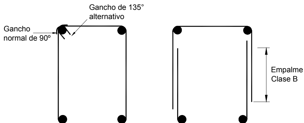
Figura 3-8 – Definición de estribo cerrado
