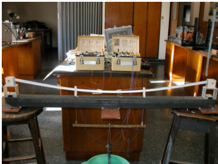
Figura 14.- Configuración deformada con 148 N de carga.
