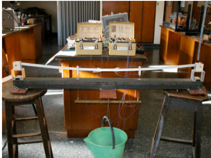
Figura 11.- Configuración deformada a los 108 N de carga.
