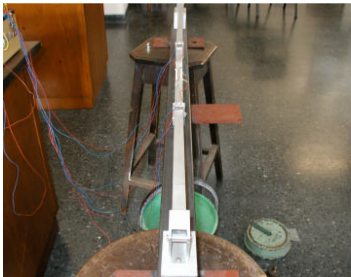
Figura 12.- Configuración deformada a 108 N de carga.
