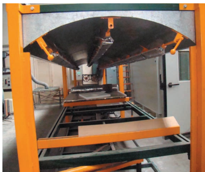
Ensayo de infrarrojo en elementos de cubiertas (Instituto Eduardo Torroja)
