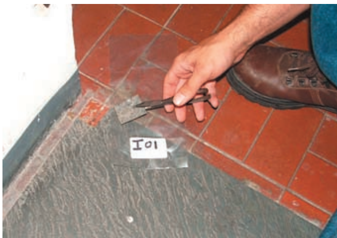
Extracción de muestra para análisis de asbestos
