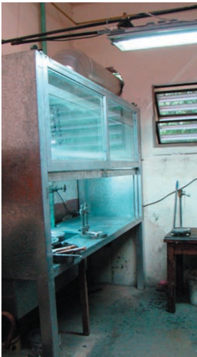
Campana de extracción de humos de fundición del material para la preparación de bases de probetas cilíndricas de hormigón
