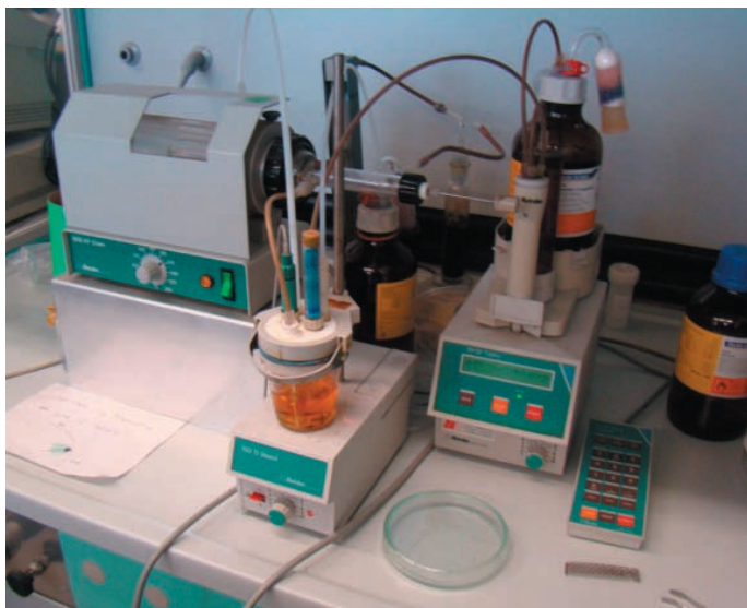
Método Karl-Fischer para ensayos del cordón orgánico de DVH (CIDEMCO)
