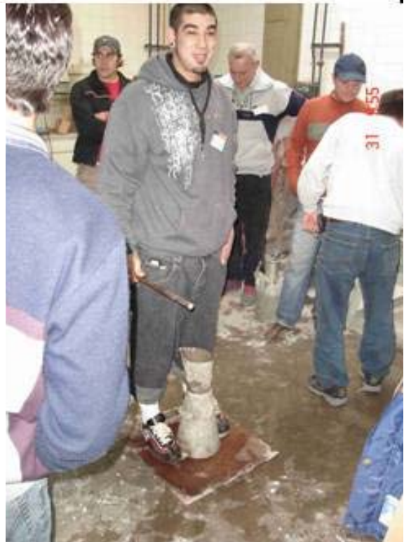
Determinación de la consistencia del hormigón fresco mediante el Método del Cono de Abrams
