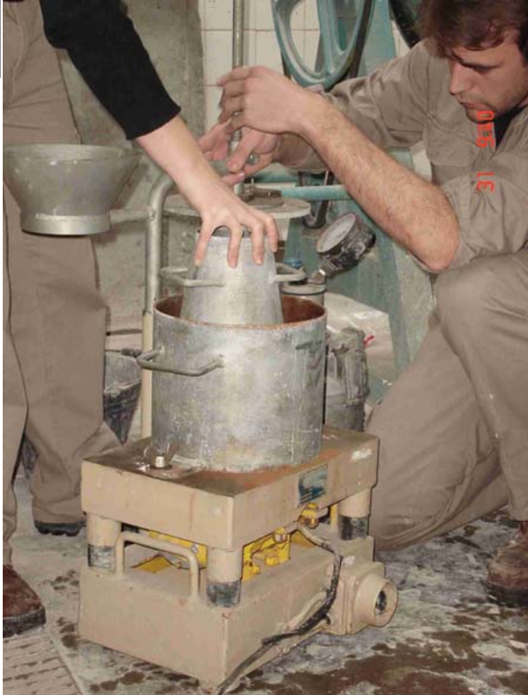
Determinación de la consistencia del hormigón fresco mediante el Método VeBe
