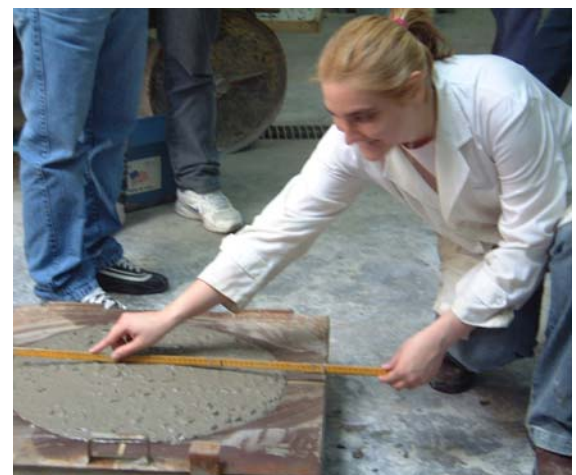
Determinación de la Consistencia mediante la mesa de Graf
