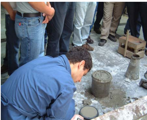
Determinación del Aire incorporado - Método de las presiones - Método volumétrico
