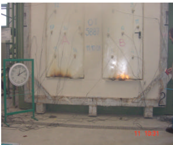
Horno de Resistencia al fuego para elementos constructivos verticales.
