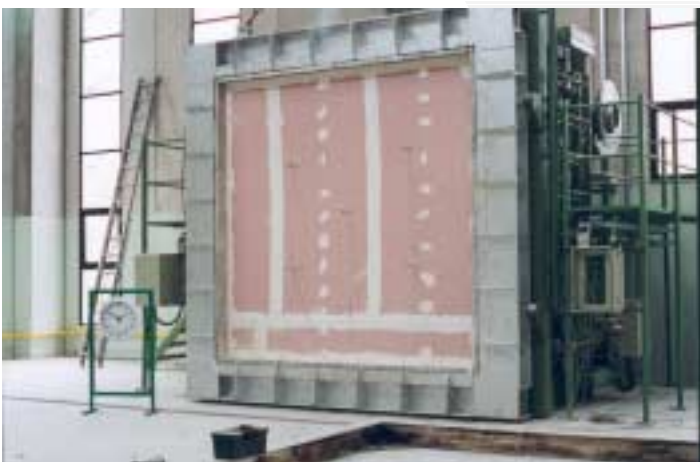
Horno de Resistencia al fuego para elementos constructivos verticales.
