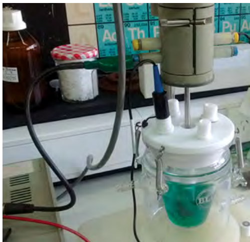
Imagen 4. celda hermética con electrodo de acero sumergido en la solución de electrólisis. El electrodo de acero está conectado con bronce roscado a una barra del Sistema rotatorio.
