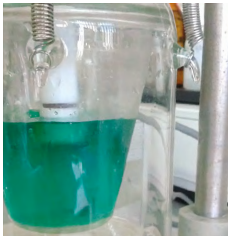
Imagen 5. celda con electrodo de acero removible
