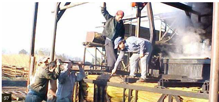
[57] Cocción de mimbre en una caldera con ayuda del polipasto. Chile.
