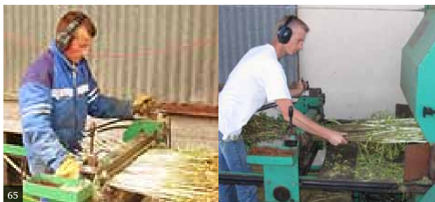
[65] Descortezado de mimbre con máquina con carretilla hidráulica. Francia.
