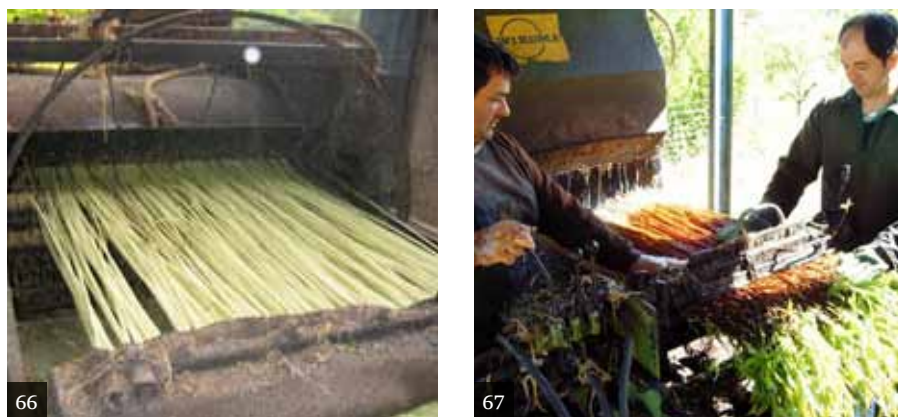
[66] Descortezado de mimbre con máquina con carretilla hidráulica. Francia.
