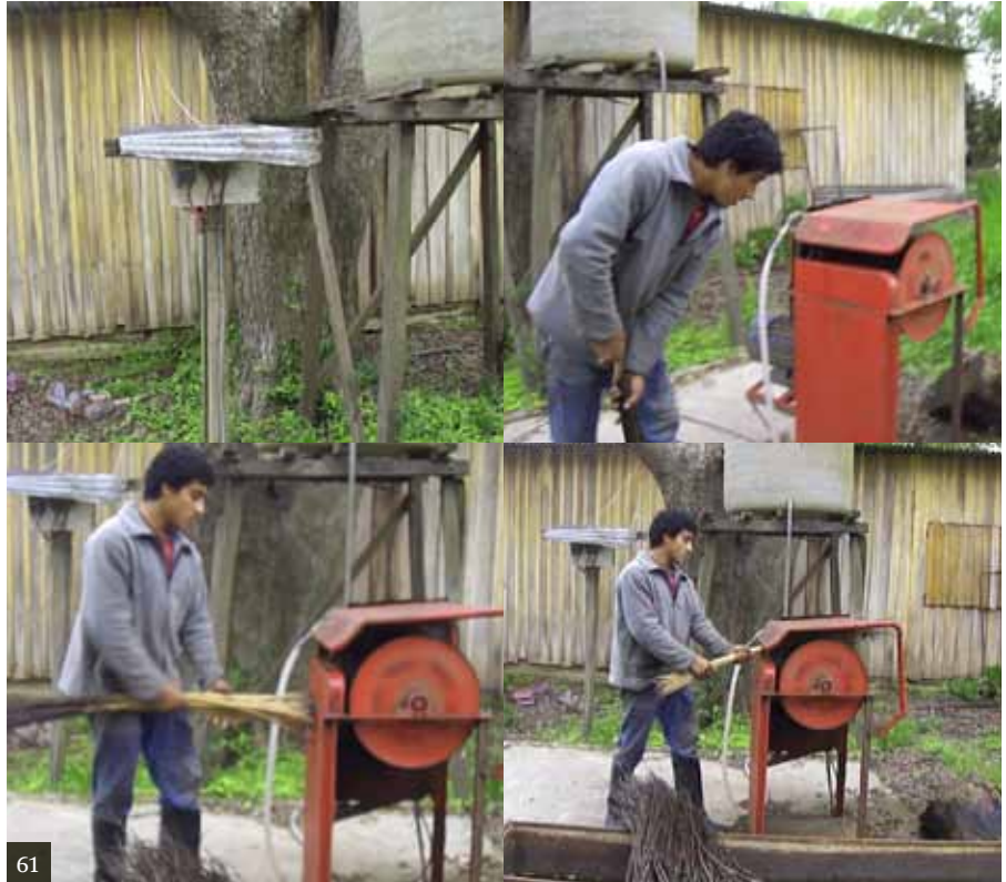
[61] Secuencia representativa del descortezado de mimbre en la Región del Delta.
