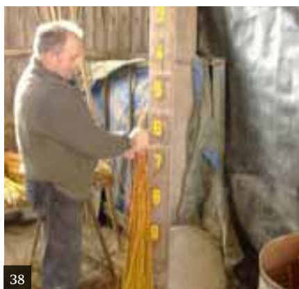
[37] Clasificación del mimbre. Golpe de las varas contra el fondo del tanque. Francia.
