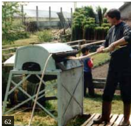
[62] Descortezado de mimbre con máquinas rotativas de muelles. Francia.
