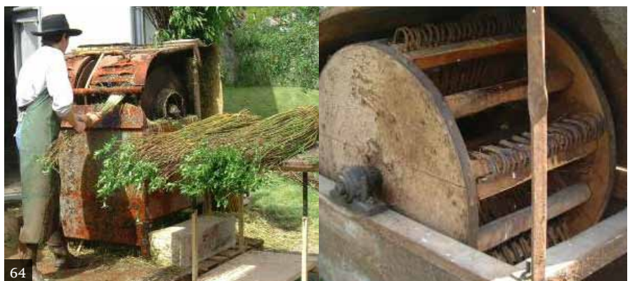
[64] Descortezado de mimbre con máquinas rotativas de muelles. Francia.
