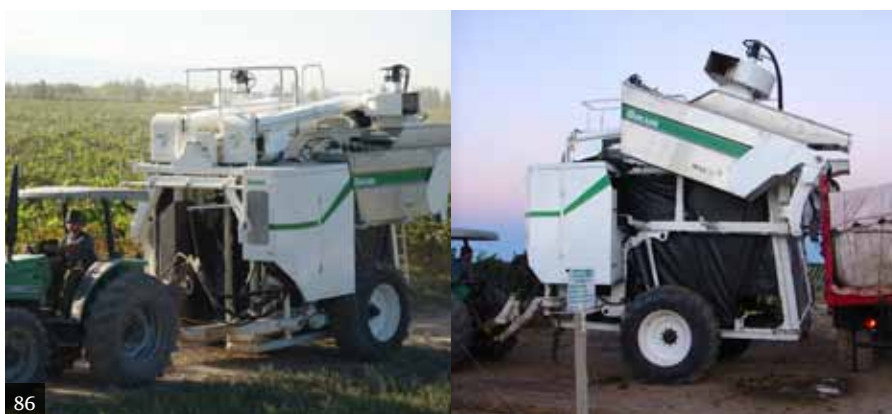
[86] Cosechadora de uvas Bacus. Maq Tec. Constituye la primera cosechadora cabalgante de fabricación argentina destinada a la cosecha de la vid. La operación del equipo se realiza acoplando la cosechadora a un tractor en el cual se monta el dispositivo de manejo de Bacus. Este último permite una eficiente regulación de la altura de trabajo, velocidad y ancho de los cabezales de cosecha, velocidad de las cintas alineación del tractor en la hilera y descarga de las tolvas.
