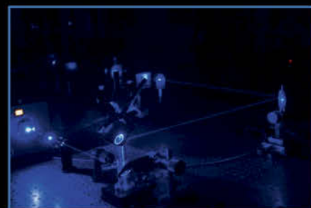
Utilización de láser rojo y azul para las calibraciones de detectores fotométricos con un radiómetro criogénico. Foto cedida por INTI.
