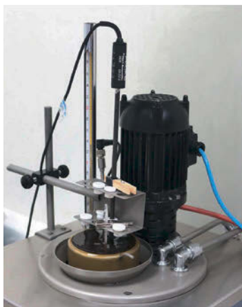
Método de calibración de temperatura midiendo con un termómetro de resistencia de platino de 100 ohms como patrón. Lo que se está calibrando es un termómetro de columna de líquido (abajo en baño de silicón) en el Centro de Investigaciones de Metrología de El Salvador.
