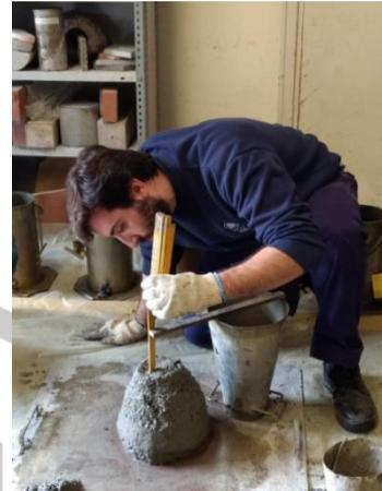
Fig. 2: Determinación de asentamiento mediante el cono de Abrams
