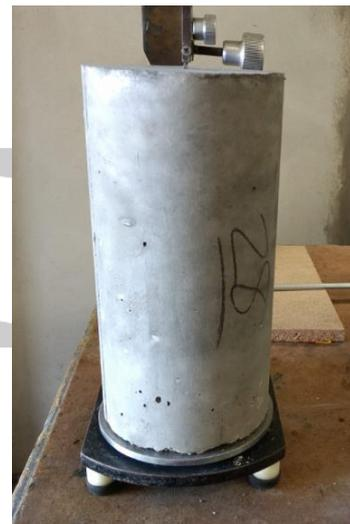
Fig. 6: Medición de altura de probetas
