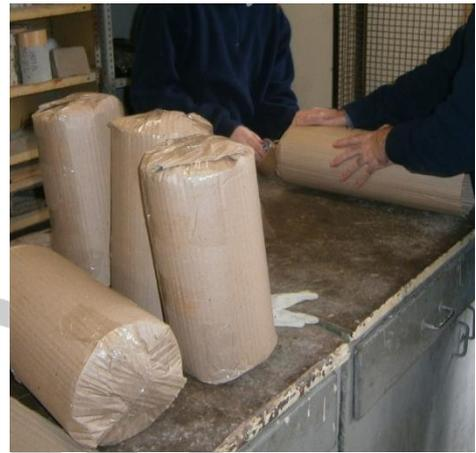
Fig. 8: Envoltura de probetas con cartón
