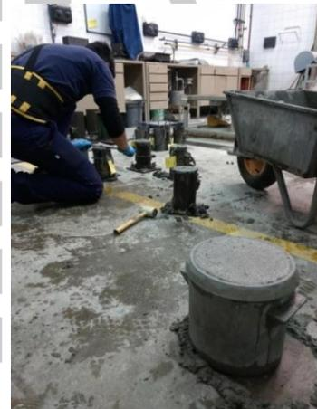
Fig. 4: Moldeo de probetas y determinación del PUV para ensayo de homogeneidad en estado fresco.
