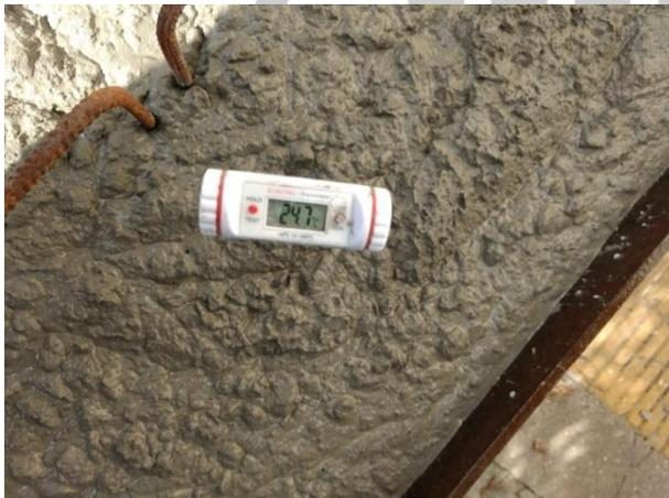
Fig. 3: Determinación de la temperatura del Pastón
