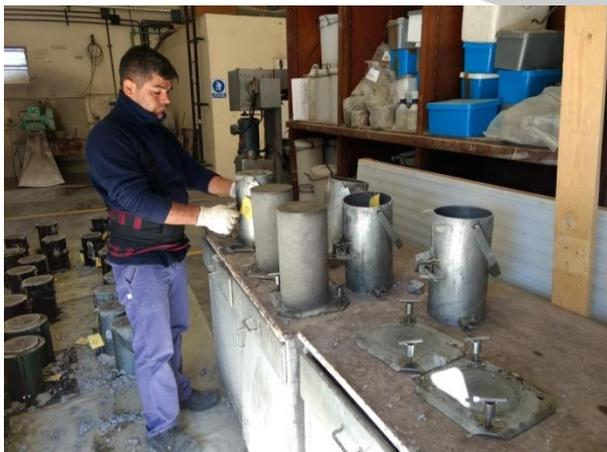
Fig 5: Desmolde e identificación de muestras
