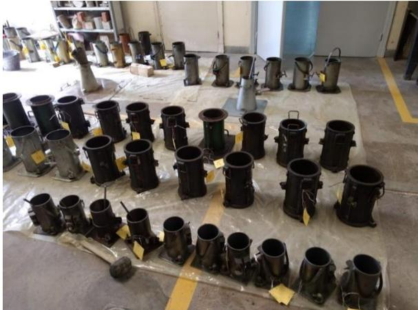
Fig. 1: Preparación de probetas para el moldeo
