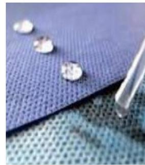
**NOTA: El ensayo de la gota es una prueba cualitativa rápida de verificación de impermeabilidad. Los ensayos para obtener mediciones cuantitativas se realizan en laboratorio con equipamiento específico, bajo condiciones y métodos de ensayos normalizados.**
