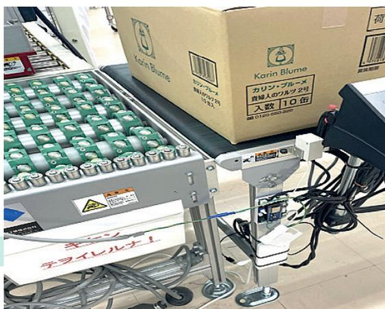
Figura 4: Dispositivo electrónico de lector de barras instalado en línea de empaquetado.
