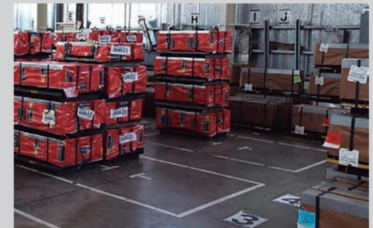
Ilustración 24 - Sectorización de almacén: columnas con letras, filas con números (Industrias Guidi)
