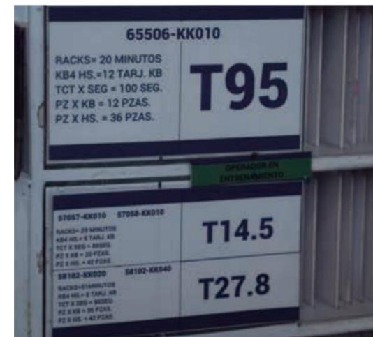
Ilustración 82 - Detalle de artículo en tablero Kanban de producción (Industrias Guidi)
