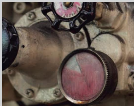
Ilustración 60 - Manómetro con control visual - Rango no deseado sombreado (Industrias Guidi)
