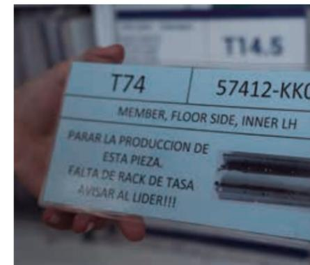
Ilustración 83 - Tarjetas JIDOKA por stock suficiente o falta de racks (Industrias Guidi)
