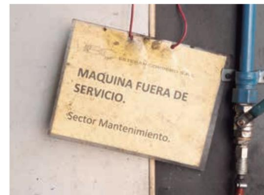
Ilustración 66 - Identificación de máquina fuera de servicio (Esteban Cordero)
