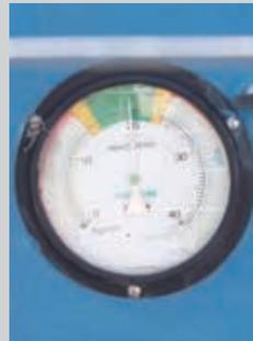
Ilustración 58- Manómetros con control visual – Rango deseado (SAI)
