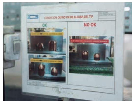
Ilustración 33 - Puesto de rectificado de tips/welding (Industrias Guidi)
