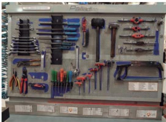
Ilustración 30 - Tablero de herramientas con demarcación de siluetas (SAI)
