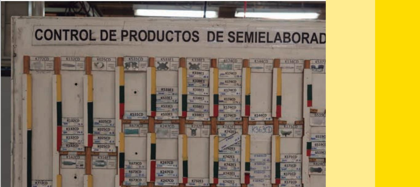
Ilustración 73 - Control de Stocks de semielaborados con semáforo (Esteban Cordero)
