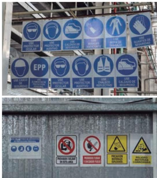
Ilustración 18 – Cartelería uso de EPP y avisos de seguridad (Industrias Guidi)
