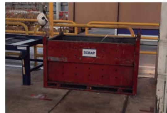
Ilustración 12 - Demarcación de piso roja para material de descarte (Industrias Guidi)
