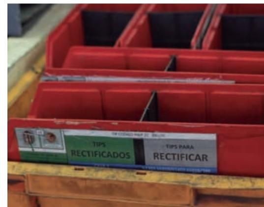
Ilustración 32 - contenedor de tips en puesto de rectificado de tips (Industrias Guidi)
