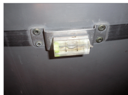
Figura 9. Nivel de burbuja adosado a un tanque enfriador.
