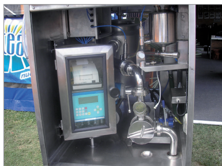
Figura 15. Sistema de medición con caudalímetro, muestreador e impresora.
