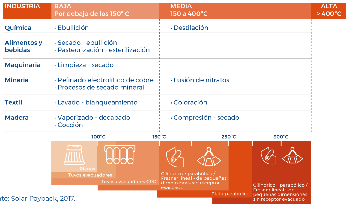
Fig. 8. Uso de calor industrial y rangos típicos de temperatura
