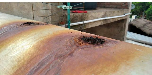
Muchas de las fisuras por corrosión son causadas por el movimiento permanente de las salidas de los tubos de venteos que no tienen un tutor correctamente instalado. El movimiento, debido por ejemplo al viento, termina fisurando la unión soldada entre el tubo y el tanque externo. En una instancia inicial, las pérdidas que se produzcan humedecerán la aislación térmica, promoviendo la corrosión bajo aislación (CUI) desde afuera del acumulador
