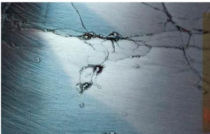
**\*La corrosión SCC en los Aceros Inoxidables Austeníticos se manifiesta como fisuras intergranulares y ramificadas. Éstas hacen perder la estanqueidad del acumulador (se pinchan), lo cual provoca primero una disminución de la capacidad de aislación térmica y rendimiento (por humedecimiento del material aislante); y, finalmente, deja al equipo fuera de servicio de manera prematura.**
