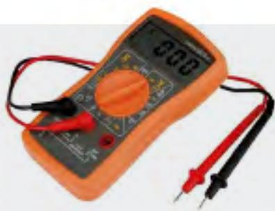
**Por medición:** mediante un multímetro en modo resistencia Ohmios, colocando un borne sobre el extremo del ánodo y el otro borne sobre el tanque metálico, se puede determinar si ambos están en contacto eléctrico/galvánico, para garantizar la protección.
