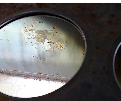
Las fisuras típicas se aprecian en la superficie interna del tanque, fundamentalmente en las zonas deformadas y próximas a las uniones soldadas del equipo.
