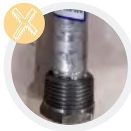
Un extremo roscado de hierro o acero es susceptible a fenómenos de corrosión.
