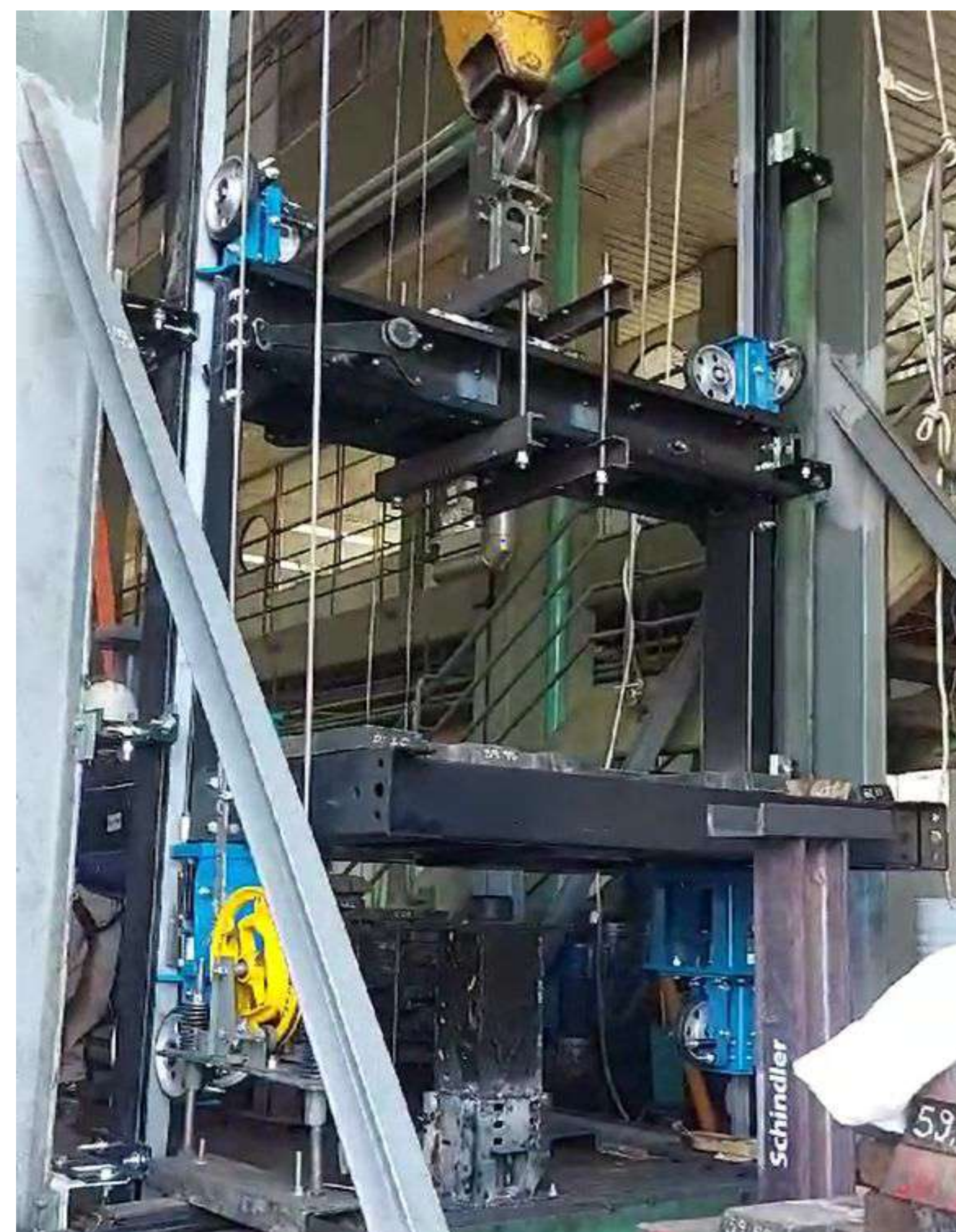
Figura 1. Torre con amortiguador bajo ensayo.
