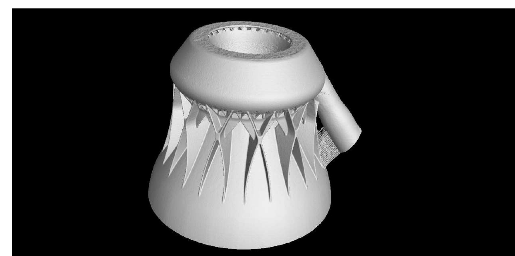
Control de calidad de un componente mediante tomografía industrial.
