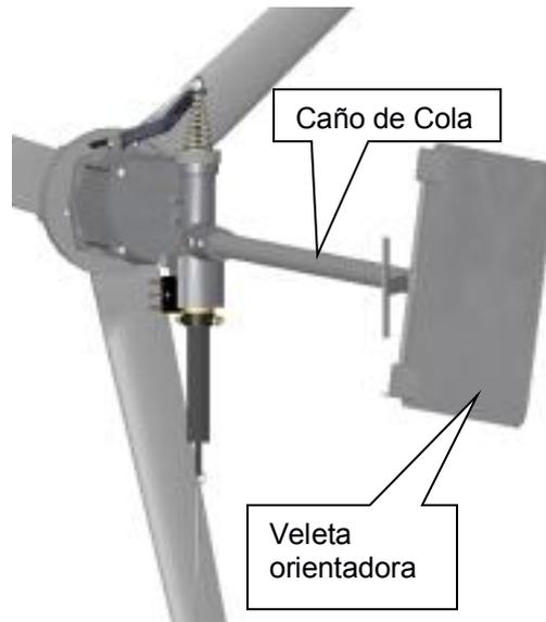
Posee un soporte de cola que sustenta la veleta orientadora y un sistema de freno mecánico accionado desde la base de la torre. En la tapa trasera del generador esta incorporado el eje vertical que soporta al aerogenerador en la puntera de la torre y además tiene incorporado los anillos rozantes y carbones que permiten la continuidad del conexionado eléctrico desde el bobinado del estator hasta el cable de bajada.
