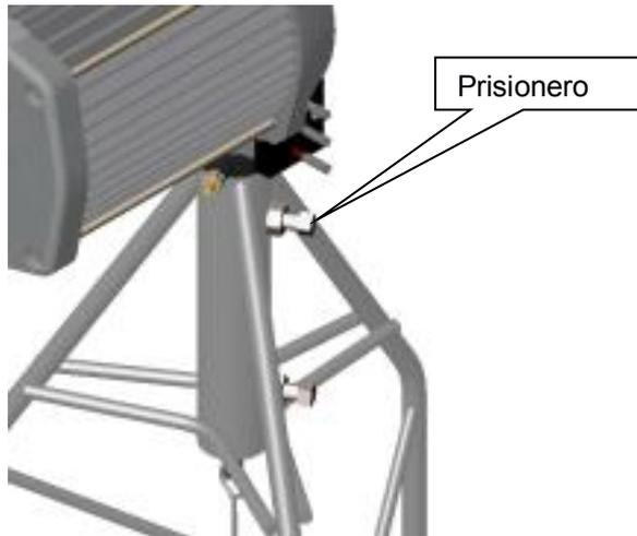
Introducir el generador en el caño de fijación ajustando los prisioneros de forma tal que quede completamente asegurado. Posteriormente se procederá a la colocación de un alambre galvanizado desde el sistema de freno del aerogenerador, hasta la palanca de freno en la base de la torre. Este sistema de freno se regula ajustando el alambre galvanizado hasta que cuando la palanca de freno este accionada no pueda hacerse girar la hélice.
