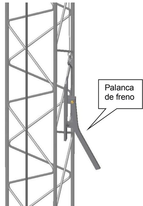
El primer tramo que se coloca tiene la particularidad de poseer soldada a la estructura la palanca del comando del freno del aerogenerador, al cual llega el alambre galvanizado que proviene desde el aerogenerador.
