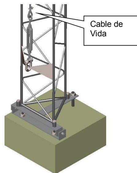
En cada tramo requerido se procederá a fijar las riendas colocando los guardacabos 20 cm. por debajo del extremo superior del tramo inferior y colocadas a 1,25 mts. del extremo superior de la torre para permitir el libre giro de la hélice del aerogenerador.
