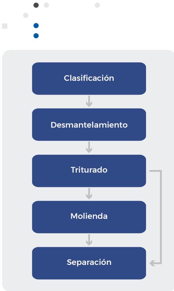
**Figura 11** | Diagrama de flujo para el pretratamiento de pilas y baterías.
