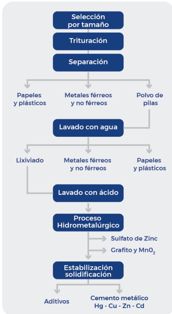
1. La lixiviación corresponde a la disolución selectiva en medio acuoso de los metales de interés a través de los reactivos adecuados y el agente lixivante encargado de realizar la disolución.
