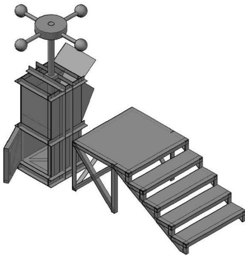
*Tamizadoras rotatorias tipo TROMMEL (consultar dimensiones en especificaciones técnicas )*
