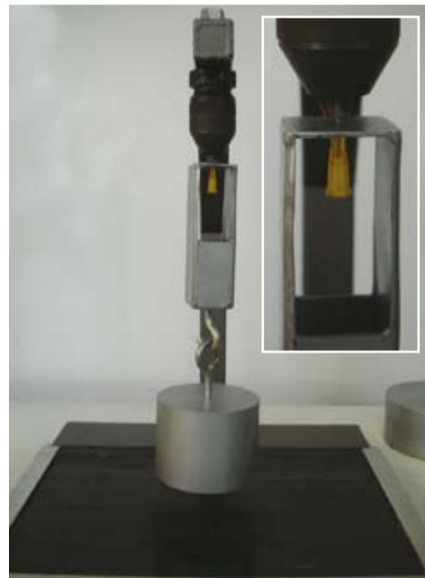
FIGURA 1 | Dispositivo de ensayo desarrollado por INTI-Mecánica para evaluar la resistencia de la unión entre el cono adaptador y la aguja.
