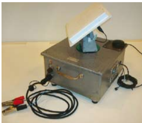
El sistema desarrollado permite redireccionar la antena que recibe las imágenes de video enviadas por el vehículo de forma automática, mediante la localización de su GPS.
