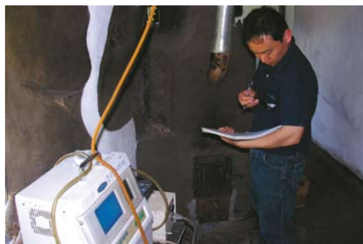
Profesional del Centro INTI-Energía mide el funcionamiento de las estufas en la Ecovilla Gaia.
