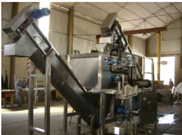
Fabricación en Mendoza de una peladora termofísica, uno de los equipos más importante para la línea de procesamiento de tubérculos empacados al vacío.
