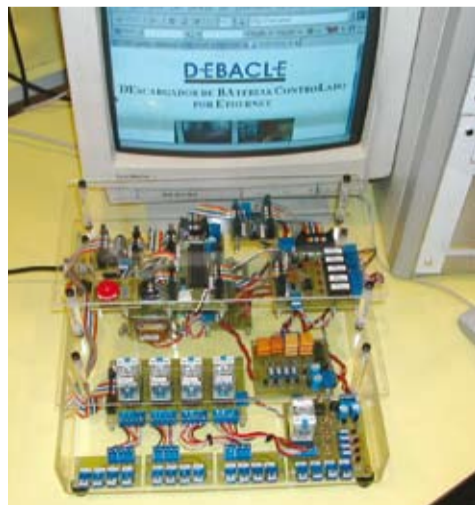
Debacle: Sistema de ensayo de descarga de baterías bajo normas ANSI desarrollado por el Centro.
