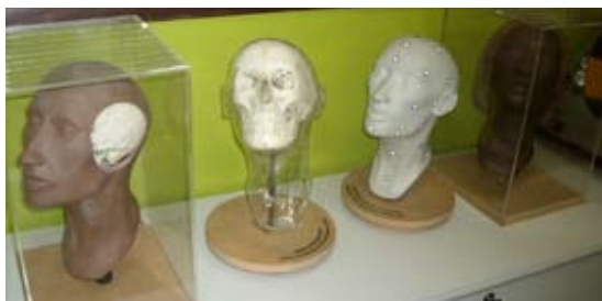
Prototipos de bebés en etapa de desarrollo y cráneos de momias, realizados a partir de modelos tridimensionales digitales con datos de resonancias magnéticas y tomografías
