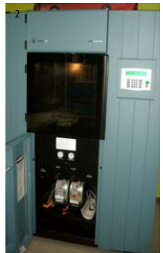
1. Impresora 3D. /2. Máquina de prototipado rápido de Modelado por Deposición Fundida./3. Pieza realizada por Estereolitografía
