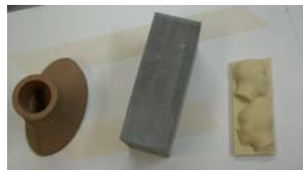
Muestras de piezas de poliuretano expandido con diversas cargas y durezas mecanizadas con dicha máquina
