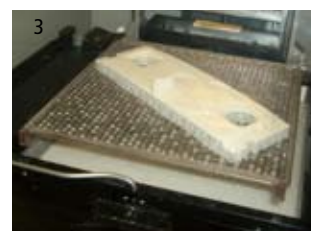
1. Impresora 3D. /2. Máquina de prototipado rápido de Modelado por Deposición Fundida./3. Pieza realizada por Estereolitografía
