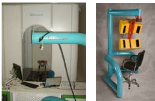
Scanner 3D de cuerpo entero y scanner de cabeza utilizado para el relevamiento de dimensiones antropométricas
