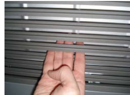
Acceso a partes peligrosas (Foto1)
