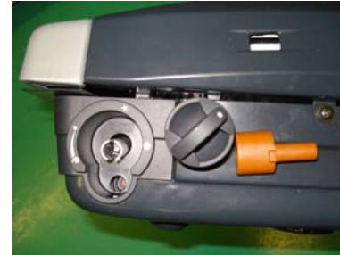
Comandos extraíbles, en este caso no permiten acceder a partes peligrosas.(Foto 4)
