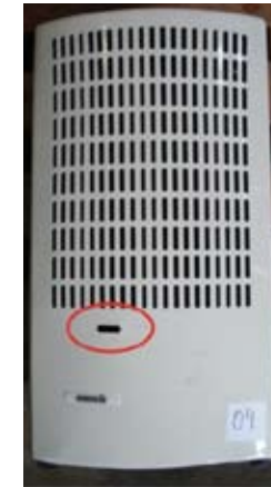
Visor de llama ubicado en la parte frontal inferior del producto. (Foto 6)
