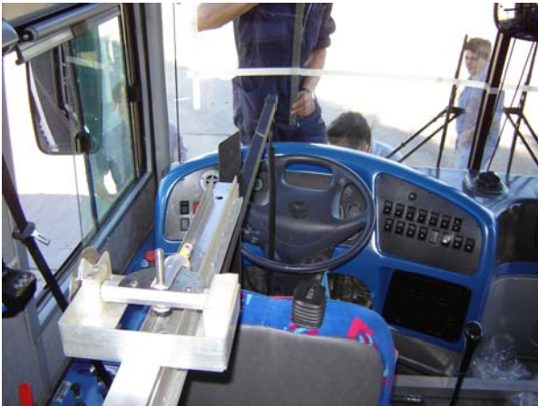
Fig. 3: Montaje del Tangenciómetro y marcado del área de visión.
