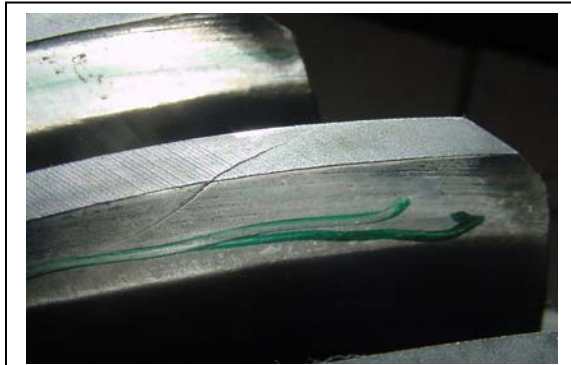
Fig. 2: Examen macroscópico. Fisura en diente de engranaje
