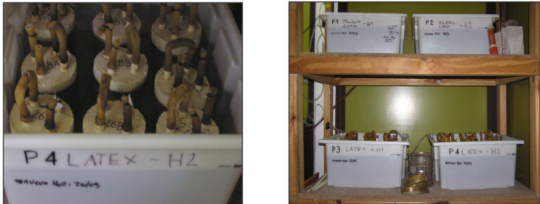
Figura 3. Piletones que contienen las probetas en inmersión en solución 3.5% p/v de NaCl.
