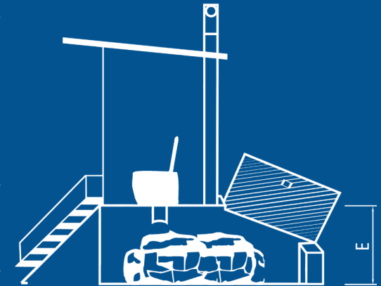
Fig.e: Visualización en corte acumulación de heces
