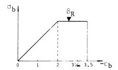
Figura 1. Diagrama tensión deformación simplificado del hormigón liviano
