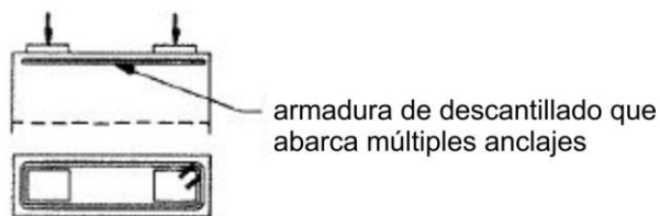
b) Armadura de descantillado entre múltiples anclajes
