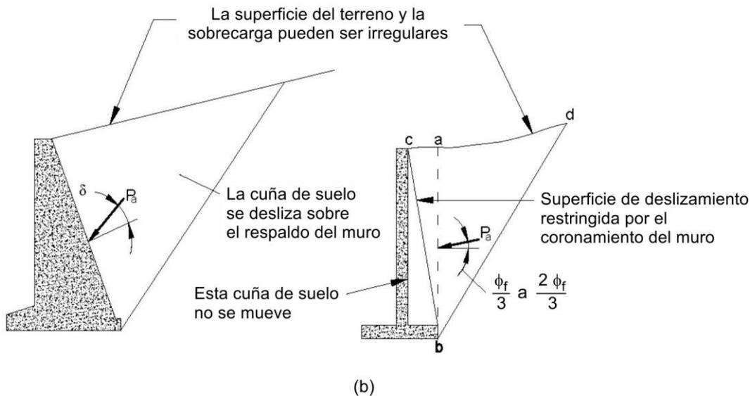
Figura C3.11.5.3-1 – Aplicación de las teorías de (a) Rankine y (b) Coulomb para el diseño de muros de sostenimiento
