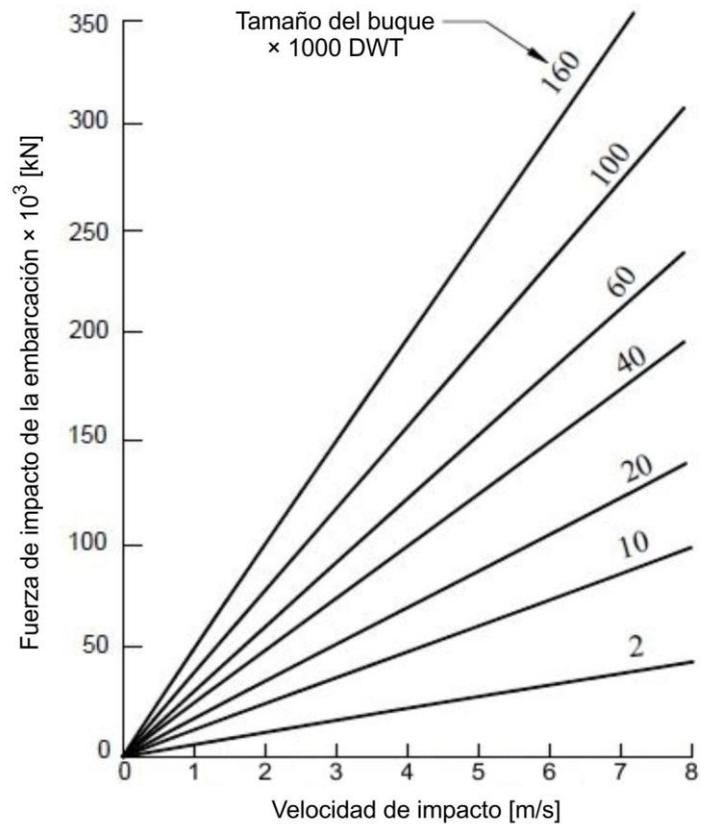
Figura C3.14.8-2 – Fuerzas de impacto de embarcaciones típicas
