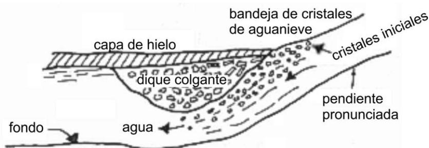
Figura C3.9.4. – Formación de un dique colgante de hielo
