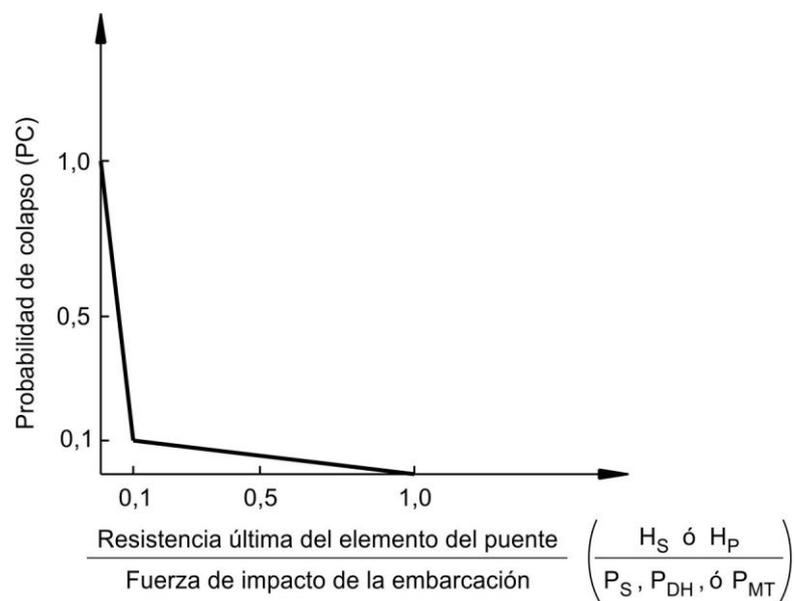
Figura C3.14.5.4-1 – Distribución de la probabilidad de colapso
