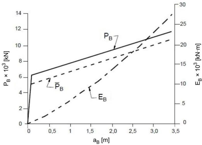
Figura C3.14.11-1 – Fuerzas de impacto de una barcaza, energía de deformación y longitud de daño
