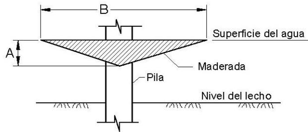
Figura C3.7.3.1-1 – Maderada para el diseño de pilas
