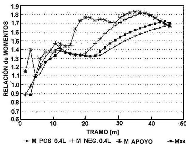
Figura C3.6.1.2.1-1 – Relaciones de momento: Vehículos excluidos sobre HS20 (camión o carril) o dos ejes de 110 kN a 1,20 m.
