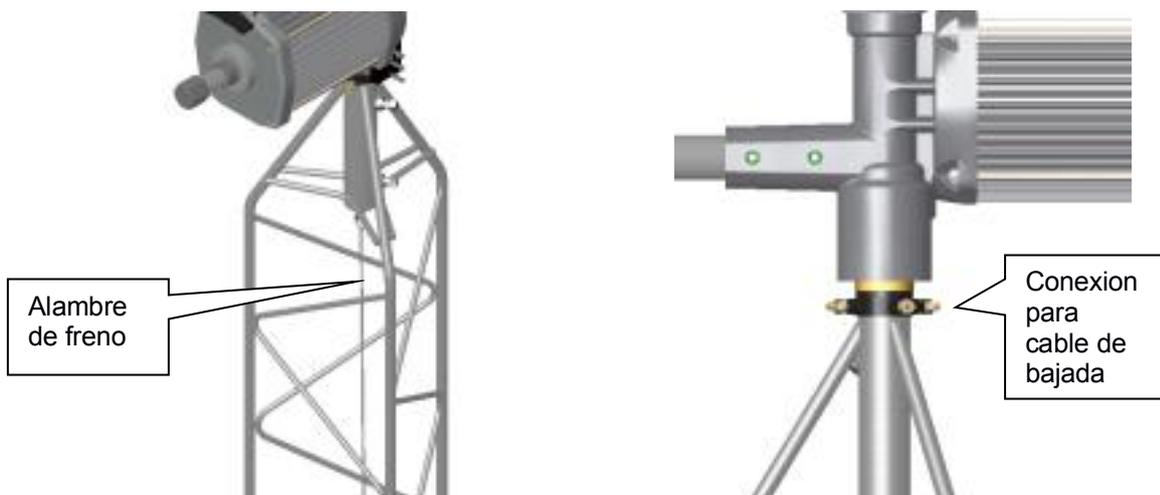
A continuación se instalará el cable de bajada de la corriente eléctrica, se recomienda usar cable forrado tipo taller o subterráneo de una sección mínima de 3 conductores por 10 mm<sup>2</sup>. en caso de instalaciones de 12 volts y 6 mm<sup>2</sup> en instalaciones de 24V.
