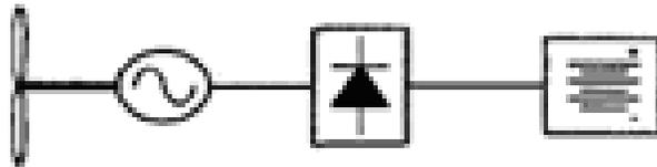
Con el esquema básico presentado anteriormente el Aerogenerador cargará las baterías siempre que el voltaje instantáneo sea superior al voltaje de la batería. Además de esto, es necesario limitar la velocidad de giro del aerogenerador para que este no se dañe, y frenarlo cuando las baterías estén llenas para no sobrecargarlas. Esto requiere de la incorporación de un elemento de frenado y un sistema de control.
